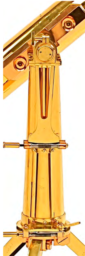
Upper: altitude adj. Lower: azimuth adj.
